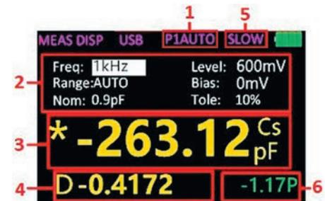
Рис. 6. Назначение полей на экране прибора (пояснения в тексте)
