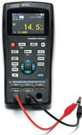
Рис. 7. Измерение индуктивности по 2-проводной схеме
