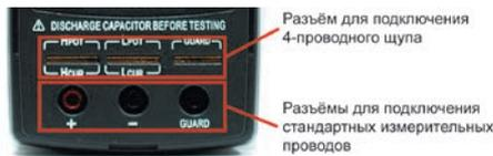
Рис. 4. Разъемы для подключения измерительных проводов
