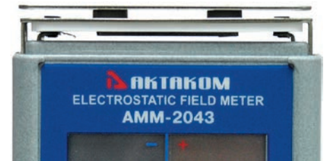
Рис. 4. Пластина для измерения ионного баланса — в зависимости от режима устанавливается в верхней или нижней части прибора
